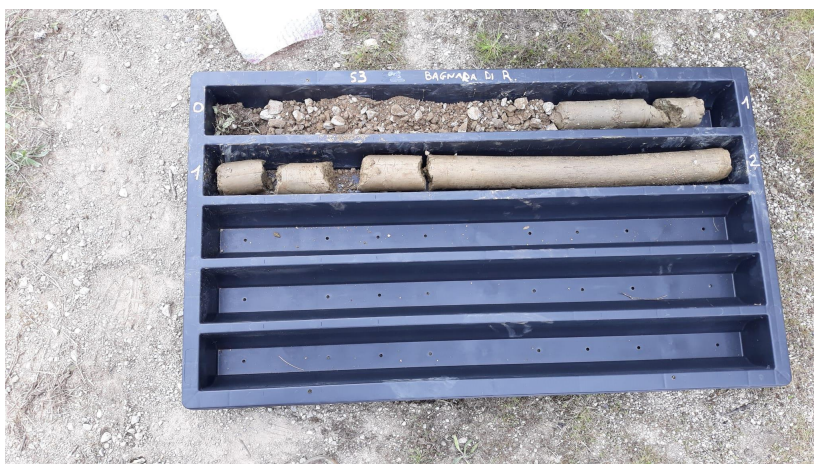
Figura 10 – sondaggio S3, cassa 0-2m
